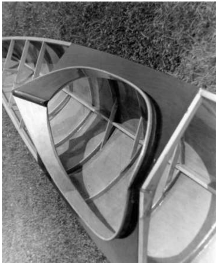
Bordás hajó a dekk felhelyezése előtt (Karpeta István gyártmánya)
