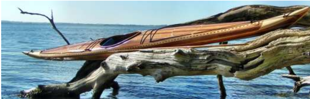
Az eszkimókajakak mintájára készített modern „ékszerdarab” lemezcsíkos építéssel készítve
