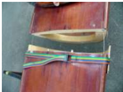
A K4 két részből való összeállítása (vezetőív felszerelése – csavarok behelyezése – összecsavarozva, szigetelve)
