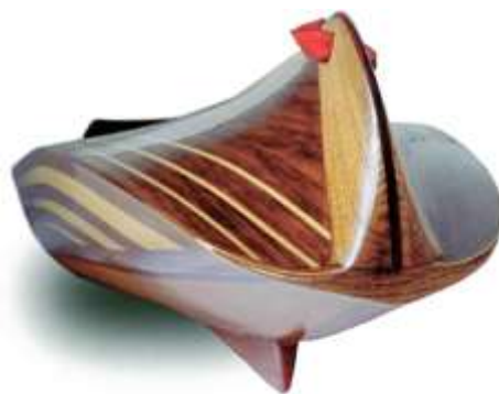
Lemezcsíkos hajó különleges kajakvég-kialakítása a stabilitás fokozására
