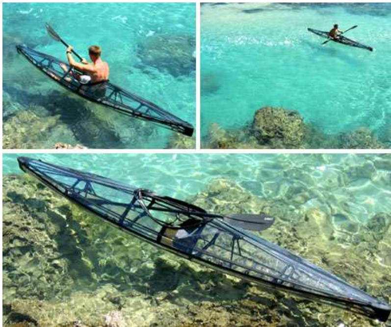
Korszerű anyagból készült összehajtható kajak
