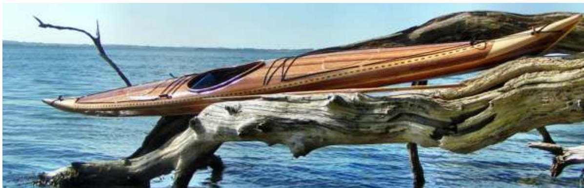
Az eszkimókajak mintájára készített modern „ékszerdarab” lemezcsíkos építéssel készítve
